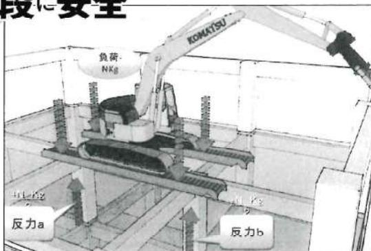
従来工法では、解体用重機がスラブ上で作業するため、床版下にサポートなどの支保工が必要で、設置数が十分でないと床版が崩落して大事故となる危険があります。CROSS-BEAMは、解体建物の梁・桁間に水平に架け渡し、その上で重機が作業するため、スラブ崩壊のおそれがなく安全に解体作業が行えます。
